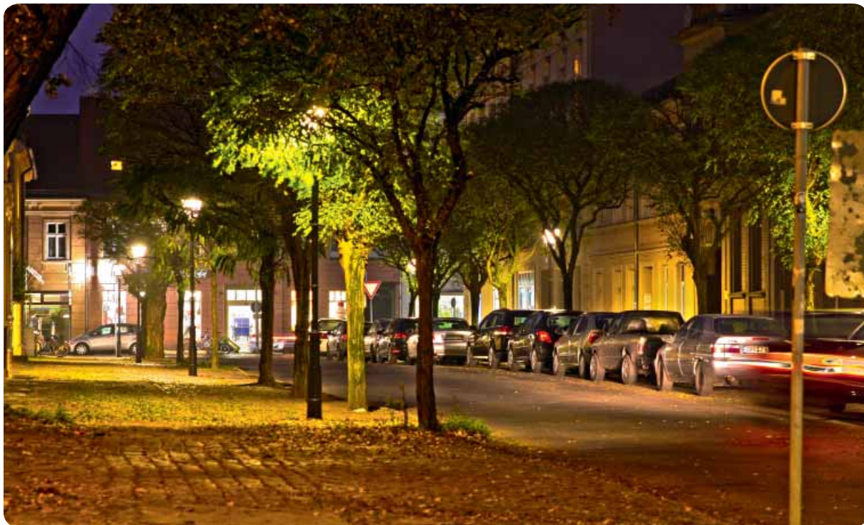
Die Robert-Koch-Straße erstrahlt seit Oktober in neuem, warmweißen Licht. Die Schinkelleuchten wurden mit einem LED-Einsatz nachgerüstet.
